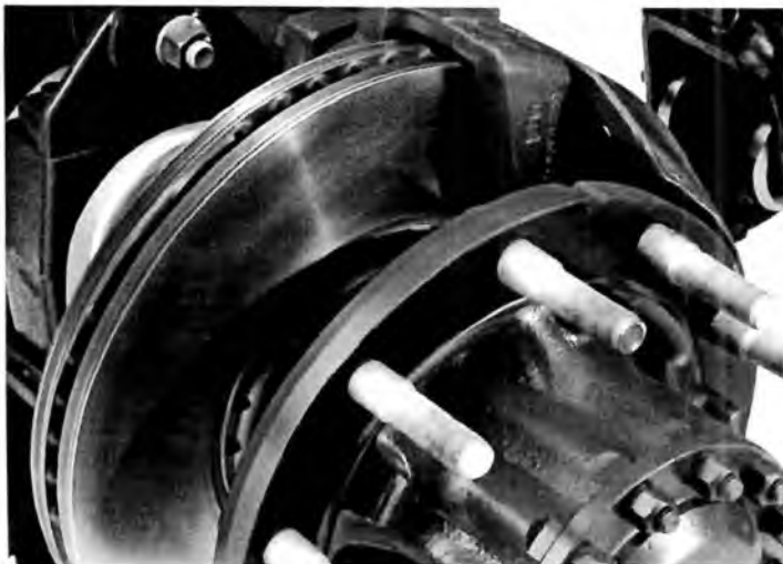
KOTÚČOVÉ BRZDY VPREDU A VZADU s ventilovanými alebo plnými kotúčmi v celom modelovom rade.
