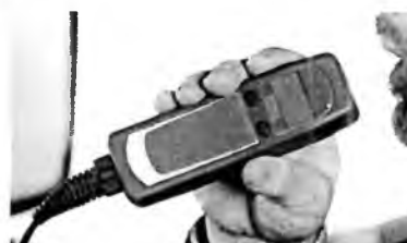
ALKOHOLTESTER S IMOBILIZÉROM umožňuje kontrolu hladiny alkoholu u vodiča pred naštartovaním vozidla.
