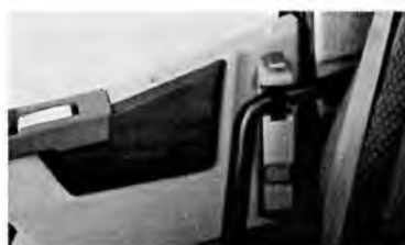
MECHANICKÉ ZAMYKANIE DVERÍ umožňuje prídavné uzamknutie dverí zvnútra vozidla.
