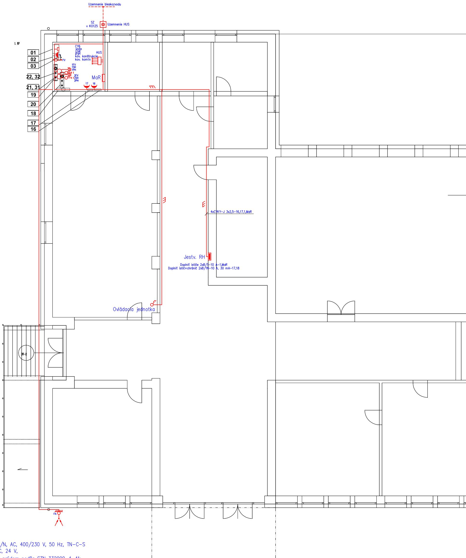
Napäťová sústava: 3/PE/N, AC, 400/230 V, 50 Hz, TN-C-S
